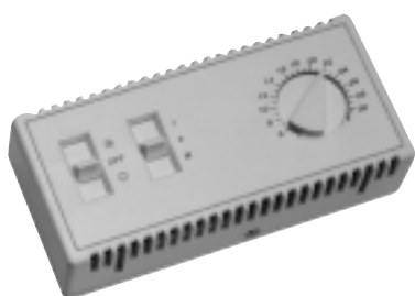
CD2/X1 Пульт дистанционного управления Откл. - Лето - Зима + 3 скорости вентилятора + электронное термореле (управление 1 клапаном)
