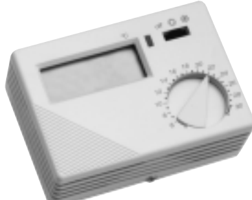
CD3/V Пульт дистанционного управления (220) Откл. - Лето - Зима + электронное термореле + автоматический выбор из 3 скоростей вентилятора + задание уставки температуры
